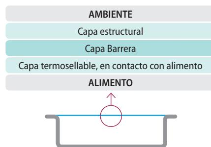
Ilustración 8: Esquema de una posible estructura de film multicapa
