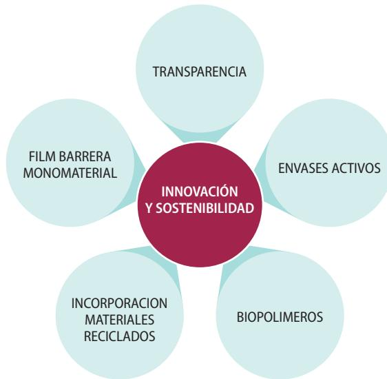
Ejemplo de estas tendencias es el desarrollo de un film flexible en PET que se puede termosellar sobre bandejas de APET, eliminando la necesidad de la capa sellable de PE. En caso de necesitar barrera, al film monomaterial se pueden incorporar aditivos de óxidos de Aluminio (ALOX), obteniendo un envase barrera de dos elementos fabricados con un solo material, mejorando su reciclabilidad.
