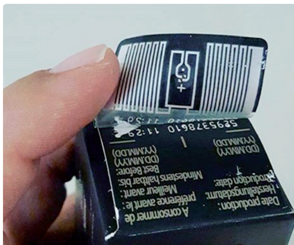
Ilustración 35. RFID aplicado a un producto de gran consumo, de alto valor añadido
