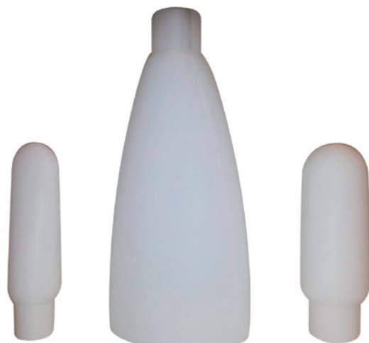
Ilustración 22. Modelos en ABS realizados mediante impresión 3D (FDM)
