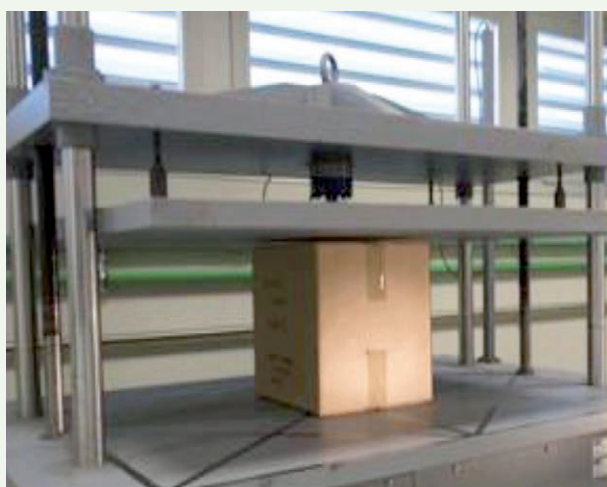
Figura 1. Ensayo de compresión y gráfica de resultados asociada.
