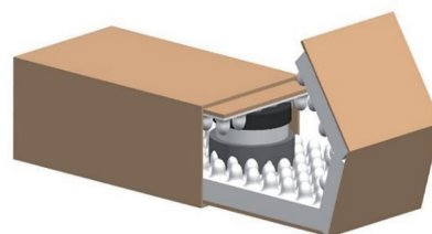
Fig 1. Embalaje e-commerce de funda y base de cartón ondulado.
